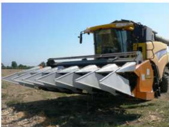
Figura 2 - Testata da cardo abbinata a mietitrebbiatrice New Holland CR 960. Sono visibili i cunei per il sollevamento del prodotto andanato.
