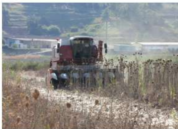
Figura 3 - Testata da cardo abbinata a mietitrebbiatrice Laverda AL 519.
